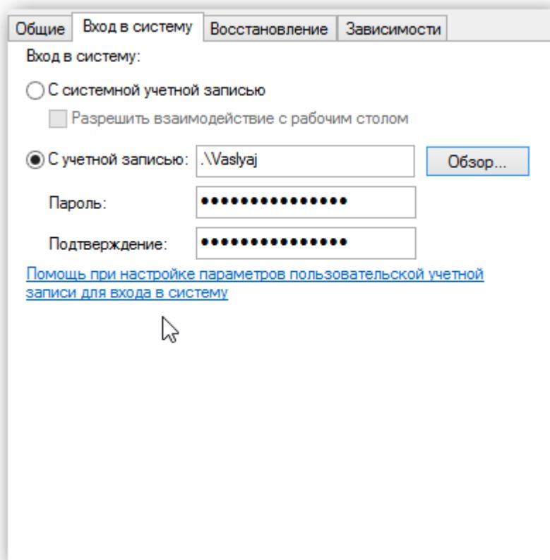
Дальнейшие действия: обзор -> дополнительно -> поиск. Выбираем конкретного пользователя с паролем!, под которым нужно будет заходить в систему, жмем «OK» и вводим пароли. Под конец нужно сделать перезапуск службы под введенным пользователем.
