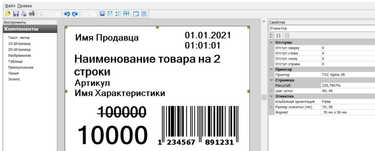
Параметры этикетки и всех ее элементов можно изменять с помощью вкладки «Свойства». Изначально в ней указаны параметры для цельной этикетки: отступы, размер, формат. Здесь можно выбрать принтер, на котором будет печататься этикетка, указать её размер.
