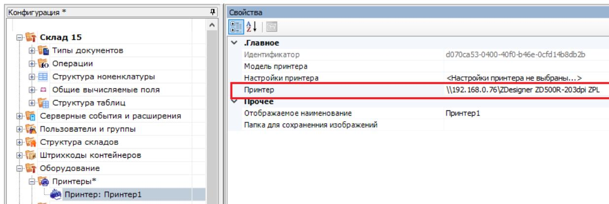
**Проблема:** при попытке печати на данный принтер с подключенного к базе ТСД на экране устройства появляется ошибка «Имя и модель принтера в панели управления указаны некорректно!» и печать не происходит.
