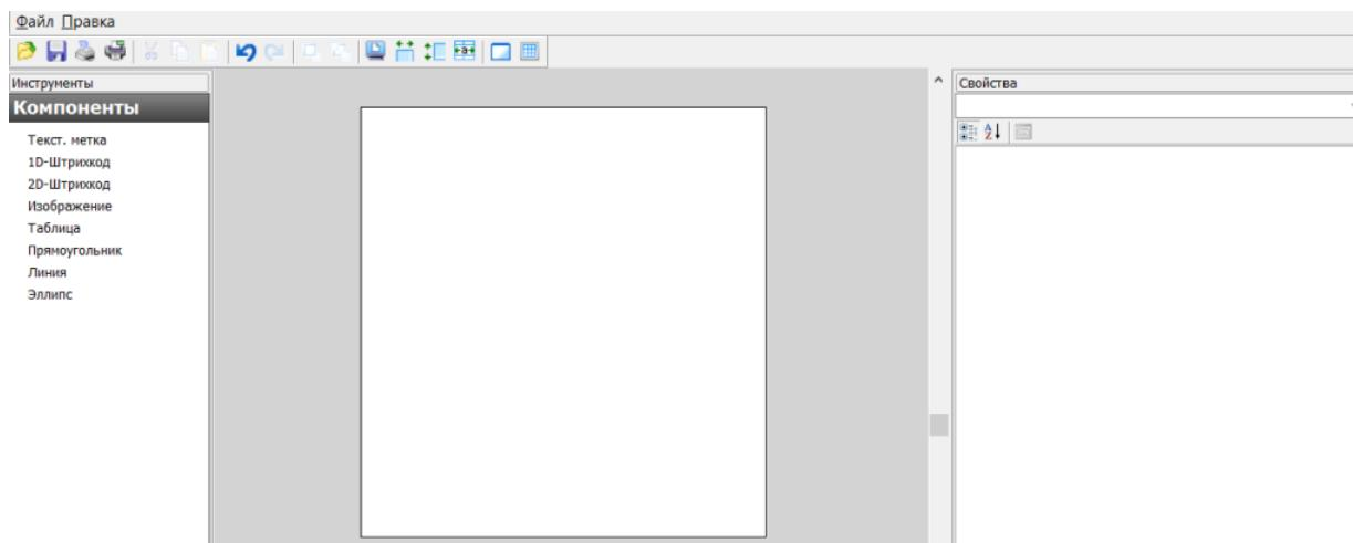
В данном редакторе можно добавлять в этикетку элементы из вкладки «Компоненты». Это могут быть штрихкоды (1D, 2D), текст, графическое изображение, таблица, графические фигуры. Каждый элемент добавляется в шаблон этикетки путем перетаскивания его в рабочую область.
