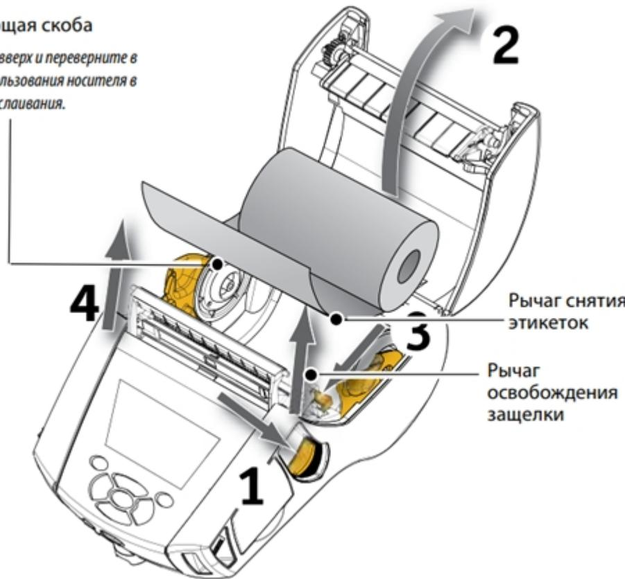
Закройте крышку отсека для носителя, чтобы зафиксировать снимающую скобу. Носитель будет пропускаться между снимающей скобой и опорным валиком.
