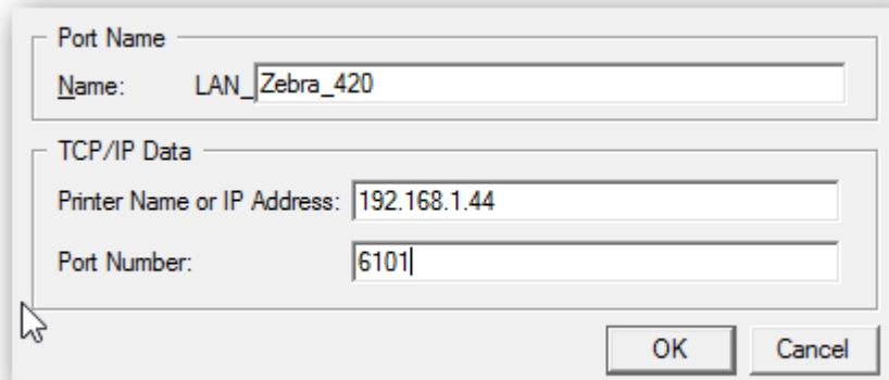
Для проверки печати нужно в Zebra Setup Utilities выбрать установленный принтер перейти на Open Printer Tools и промотать пустой label:
