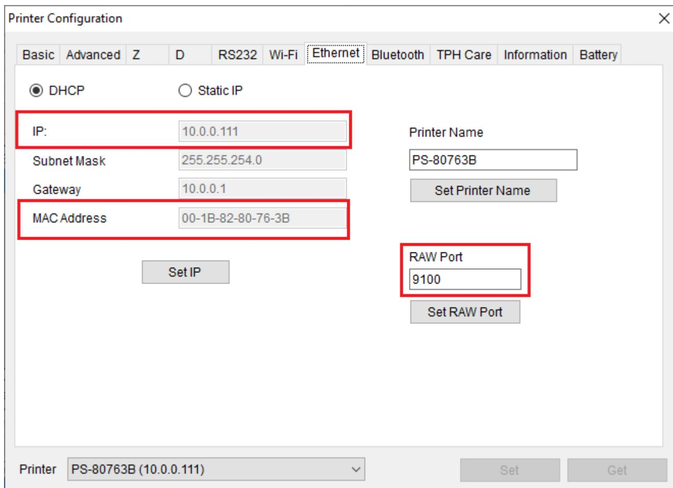
Если в сети нет DHCP сервера, с помощью этого ПО также можно задать статический адрес IP и порт, но только подключив принтер по USB или COM к ПК.
