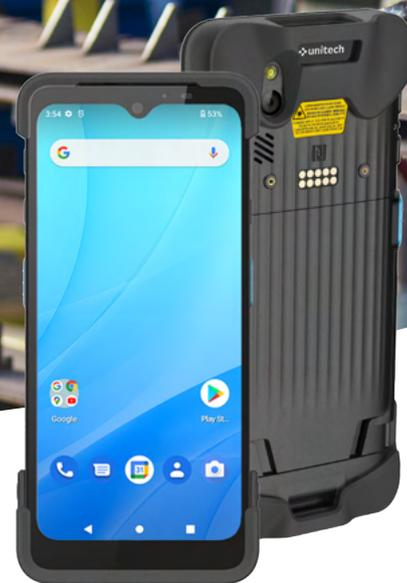
5G и Wi-Fi 6E | Расстояние считывания штрих-кода : до 10 м | Горяче заменяемая батарея емкостью 5100 мАч с UL-сертификатом
